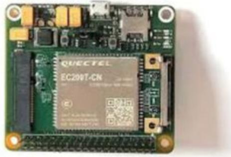
2. Attach the antenna to the mini PCIe module.
